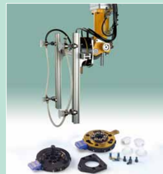
標準吸盤組與選配的快速換治具 (QR)
